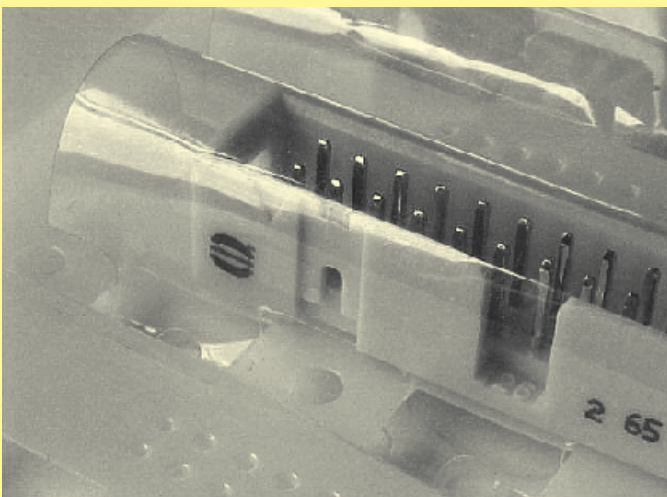
封装在胶带内的SEK连接器，准备用异型装配站进行贴装。
