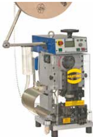
图V-18: BK 型压接机(全自动机器)
