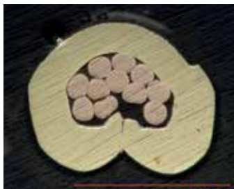
图 V-7: 缺陷样品的微截面, 导线截面积太小
