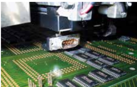
图 IX-5: 带有真空吸管和 D-Sub 的取放机
