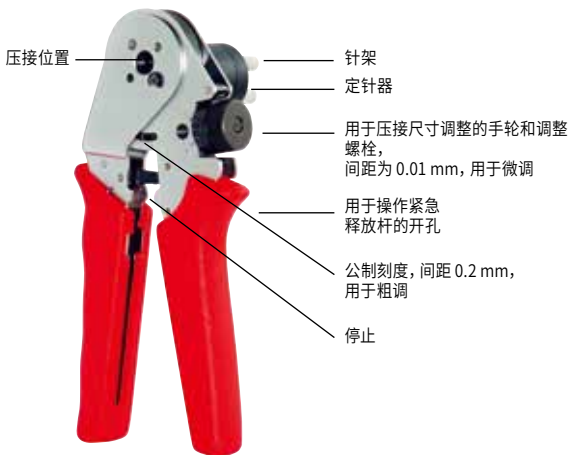
图 XIII-16: 四爪压接工具
