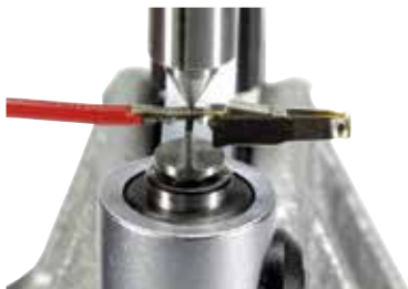
图 V-11: 测量尖头之间的压接针的细节图
