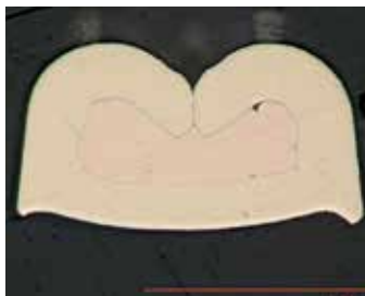
图 V-5: 无缺陷样品的微截面
