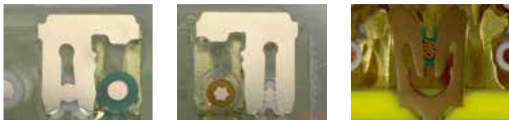
图 XI-1: 刚性和柔性 (绞合) 导线的最佳绝缘刺破
