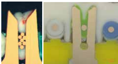
图 XI-2 和 XI-3: 不良绝缘刺破
