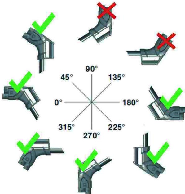
安装的复位位置需要防止误操作，以颠倒的方式（90° 至 135°）悬挂车辆连接器。
